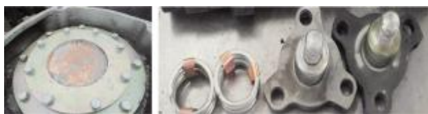
图2 防爆板密封良好、芯体金属件无锈迹
