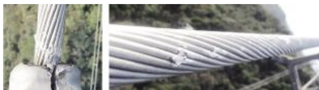
图1 A相、C相导线放电痕迹
